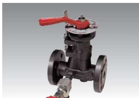
Тип 560 Соединение: фланцы DN: 15 до 20 Материал: литая сталь, PN-40 Уплотнение: металлическое
