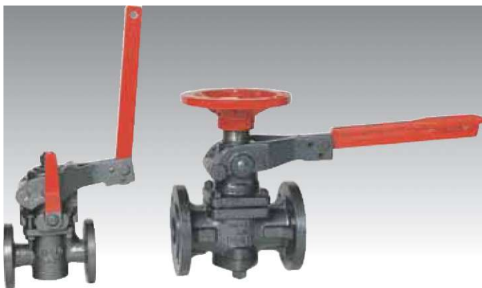
Тип 260 Соединение: фланцы DN: 20 до 50 Материал: литая сталь, PN-40 Уплотнение: металлическое
