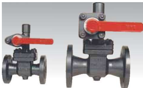
Тип 460 Соединение: фланцы DN: 25 до 50 Материал: литая сталь, PN-40 Уплотнение: металлическое
