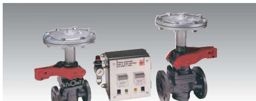
Тип 260-A Соединение: фланцы DN: 20 до 50 Материал: литая сталь, PN-40 Уплотнение: металлическое
